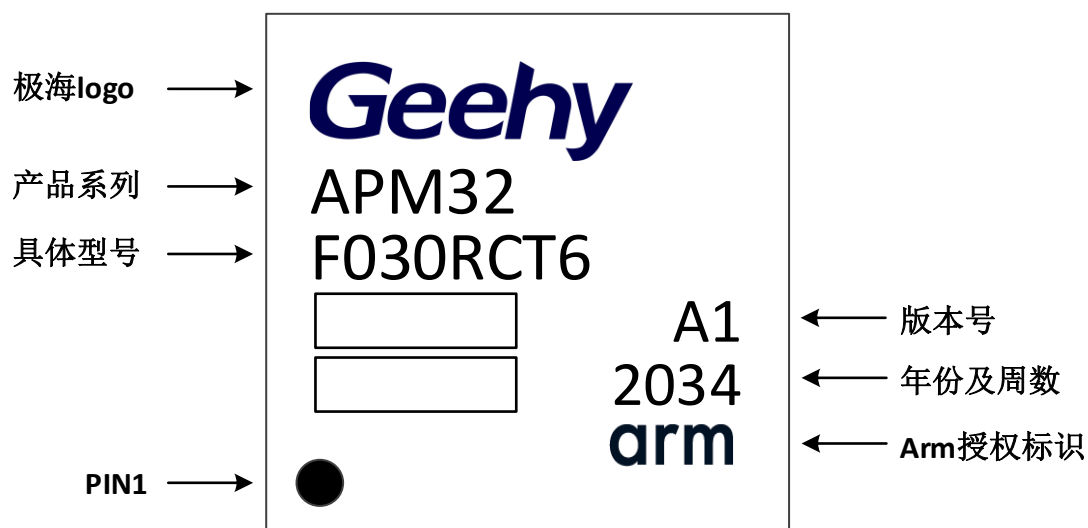
图 16 LQFP64-64 引脚，10×10mm 封装标识
